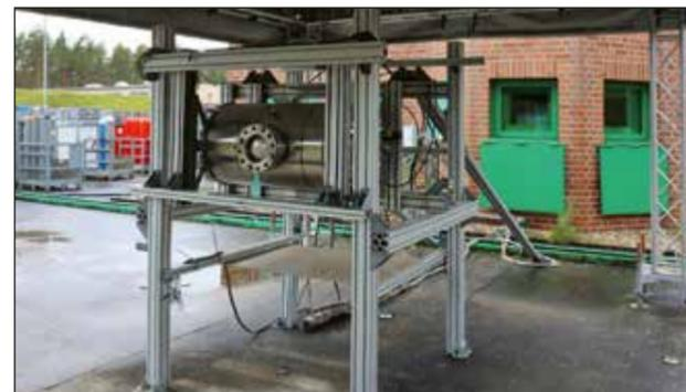
Abb. 2: Detailansicht des Stoßwellengenerators
