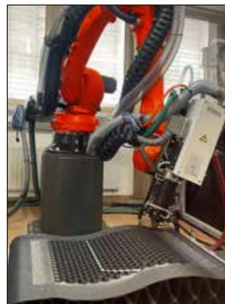
Abb. 2: Überdrucken von gekrümmten Thermoplast-Laminaten mit komplexen Strukturen
