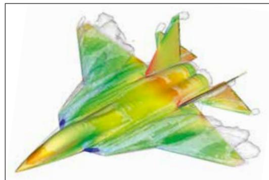
Abb. 2: Druckverteilung und Wirbeltopologie auf der Oberseite des DLR-FFD
