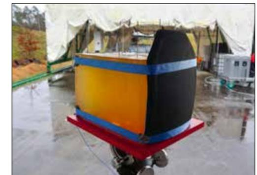
Abb. 4: Das vereinfachte Torso-Modell mit einer PE-Körperschutzplatte zur qualitativen Untersuchung
