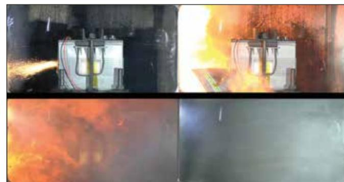
Abb. 2: Beim Beschuss von Lithium-Ionen-Batterien kann es in Abhängigkeit der Zellchemie zu schlagartiger Brandentstehung und explosionsartiger Freisetzung von heißen Gasen und Partikeln kommen
