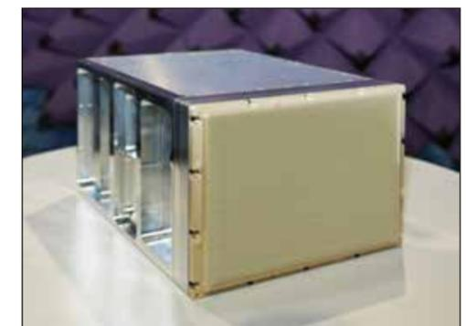
Abb. 4: Systemträger zur Aufnahme von 8x4 Send-/Empfangsmodulen mit Bereitstellung von Strom- und Signalversorgung sowie Kühlinfrastruktur
