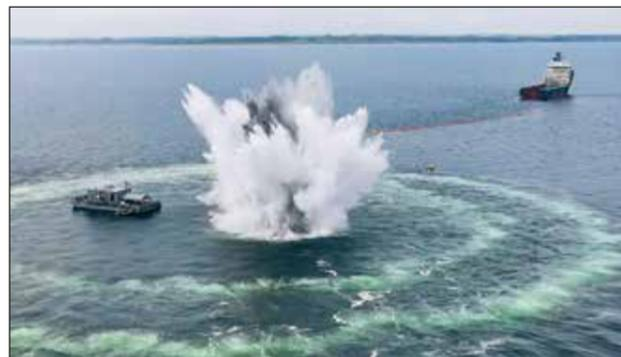
Abb. 1: Unterwasser- Detonation einer Sprengladung von ca. 100 kg TNT-Äquivalent im Sept. 2023 im Sperrgebiet vor Schönhagen in der westlichen Ostsee. Um die Ladung herum heben sich die zwei konzentrischen Blasenschleier ab (Quelle: WTD 71 GF 440)
