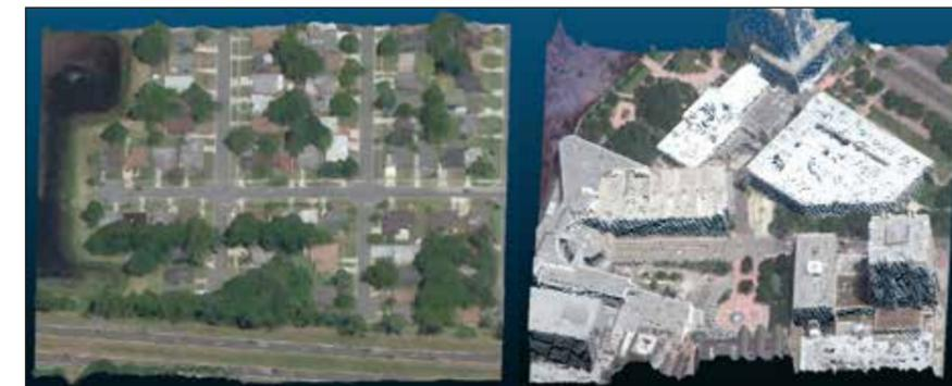
Abb. 2: 3D-Punktwolken basierend auf zwei impliziten Szenendarstellungen, rekonstruiert mit einem NeRF-Modell
