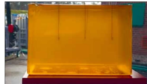
Abb. 3: Detailansicht des vereinfachten Torso-Modells. Es sind drei eingegossene Drucksensoren zu erkennen
