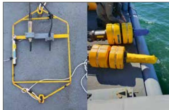
Abb. 2: Für die Messungen von Bord verwendete Hydrophone (links) und AMAR-Hydrophonbojen für Messungen in größeren Entfernungen von der Sprengstelle (rechts)
