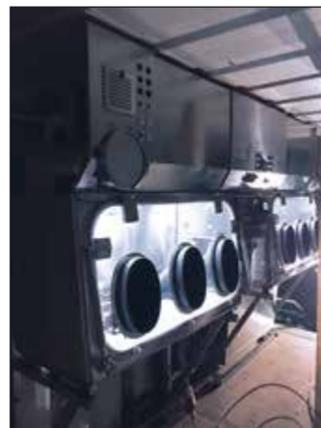
Abb. 2: Das Werkbanksystem verfügt über eine automatisierte Filterdichtheits-Prüfung
