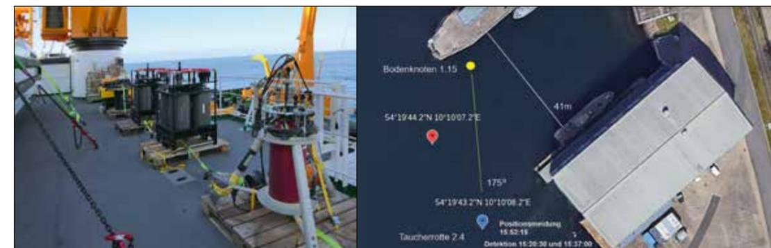
Abb. 2: Links: Bodenknoten vor der Auslegung auf FS Planet, rechts Peilung der annähernden Fremd-Taucherrotte durch den Bodenknoten in der Richtung 175° im Arsenalbecken in Kiel mittels hydroakustischer Detektion
