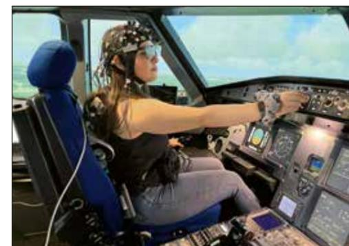
Abb. 3: Innenansicht des Flugsimulators AVES mit Probandin und angelegten Geräten
