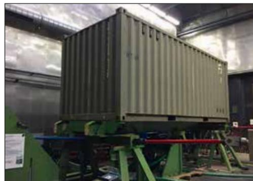
Abb. 1: Belastungsprüfstand (WTD 41, Trier), eingerüstet in einen Prüfcontainer mit dem technischen Baustein Werkbanksystem
