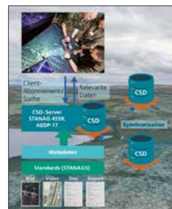
Abb. 3: Datenspeicherung und -verteilung mit einem CSD-Server gemäß STANAG 4559 AEDP-17 (Illustrationen: AdobeStock, 259325121, AleksViking)
