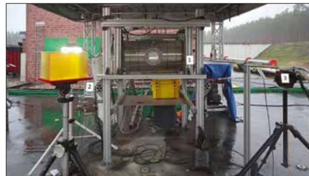
Abb. 1: Grundlegender Versuchsaufbau. 1.: Stoßwellengenerator; 2.: Vereinfachtes Torso-Modell; 3.: Druckmesstechnik
