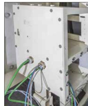
Abb. 3: Der Batteriekasten in einem gepanzerten Fahrzeug zur sicheren Kapselung von Lithium-Ionen-Batterien stellt eine wichtige Schutzeinrichtung für die Insassen dar
