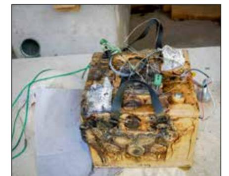
Abb. 4: Lithium-Ionen-Batterie im NATO-6T-Format, nachdem das thermische Durchgehen einer Zelle für den Sicherheitstest im Fahrzeug gezielt provoziert wurde
