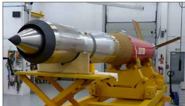
Abb. 1: APEX-TD vor der finalen Integration an die Abschuss-Plattform mit geöffnetem Einlauf und Red Kite Raketenmotor
