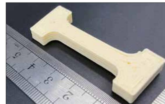
Abb. 3: 3D-gedruckter Vielzweckprüfkörper zur Beurteilung der mechanischen Eigenschaften und der Reproduzierbarkeit des 3D-Druckprozesses
