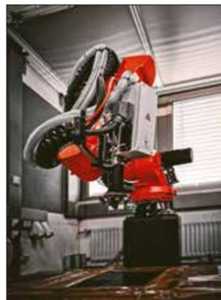
Abb. 1: Robotische 3D-Druck Anlage zur additiven Fertigung von Hochleistungsthermoplasten
